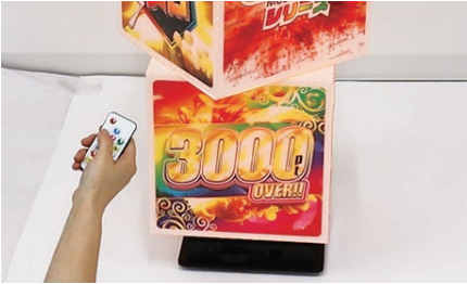
②リモコンのスイッチを入れる 上記画像のようにリモコンのスイッチを入れてください。 ※土台の電源が入っていないと、リモコンに反応しません。
